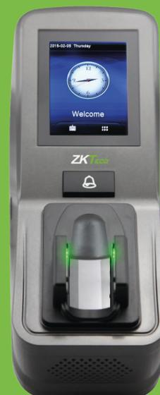
El V350 es una terminal biométrica IP con un lector de venas de los dedos de la mano, integrado para aplicaciones de control de acceso.
